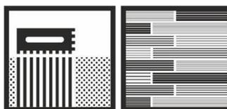
Um die Fliesen zuschneiden Holz- oder Metallsäge benutzen. Die Montagearbeiten in den Temperaturen zwischen 5°C und 25°C durchführen. Um einen Unterschied in den Farbtönen der Fliesen zu vermeiden, wird empfohlen, Produkte aus einer Produktionscharge zu kaufen. Der Produzent berücksichtigt keine Reklamationen, die die in großen Zeitabständen gekauften Fliesen betreffen.
