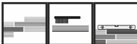
Fliesen aus verschiedenen Verpackungen zugleich benutzen, um eventuelle Farbtonunterschiede zu reduzieren. Bei fehlender waagerechten Unterstützung für Fliesen eine Startleiste anwenden. Zum Fliesenverlegen den universalen MAXGLUE-Fliesenkleber benutzen. Klebe wie in der Gebrauchsanweisung auf Verpackung auftragen. Die Fliesen sollen nicht in einer senkrechten Reihe verlegt werden. Die besten Effekte erzielt man mit Verschiebung um ½-Breite der folgenden waagerechten Fliesenreihe.
